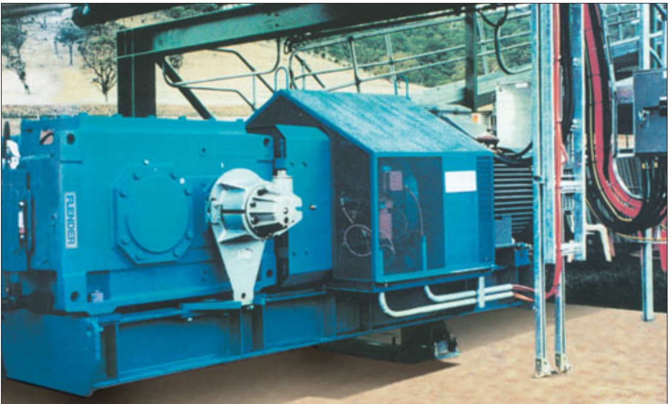
Gurtförderantrieb mit FLENDER-Kegelstirnradgetriebe B2SH Größe 12 (P = 220 kW) und Rücklaufperre, Dartbrook / Australien Belt conveyor drive with FLENDER bevel-helical gear unit B2SH size 12 (P = 220 kW) and backstop, installed in Dartbrook / Australia Convoyeur à bande avec réducteur cylindro-conique FLENDER B2SH taille 12 (P = 220 kW) et antidévireur, Dartbrook / Australie
