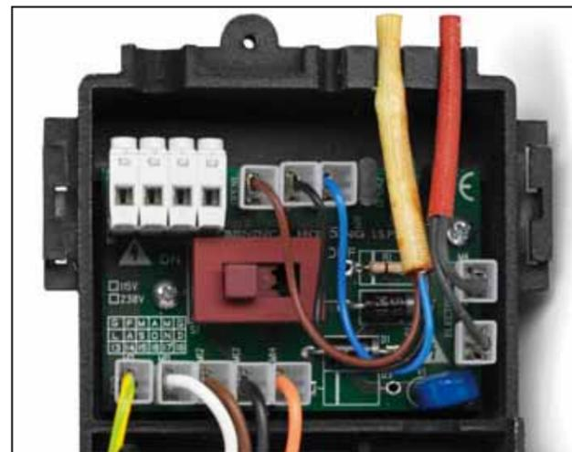
Nuovo finecorsa automatico caratterizzato da connessioni rapide e veloci, morsettiere estraibili e alimentazione elettrofreno integrata, consente una regolazione automatica sia in apertura che in chiusura.
