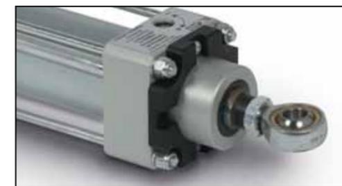
La presenza dello snodo posteriore a perno e dello snodo anteriore sferico regolabile agevola le operazioni d'installazione, consentendo il corretto funzionamento anche con cancelli non perfettamente allineati.
