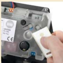
Nuovo sistema di cifratura del trasmettitore BY che consente di conservare il sistema di sicurezza dei telecomandi rolling code con in più la possibilità di aggiungere via radio più telecomandi alla centrale del sistema senza l'utilizzo di un programmatore.
